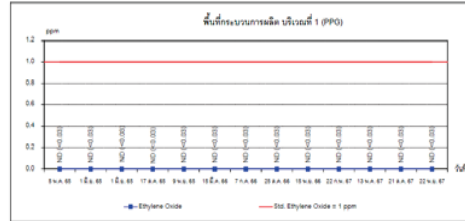
ภาพที่ 4.47 กราฟแสดงผลการตรวจวัด Ethylene Oxide ในพื้นที่ทำงาน บริเวณ พื้นที่กระบวนการผลิต บริเวณที่ 1 (PPG) ระหว่างปี พ.ศ. 2565-2567
